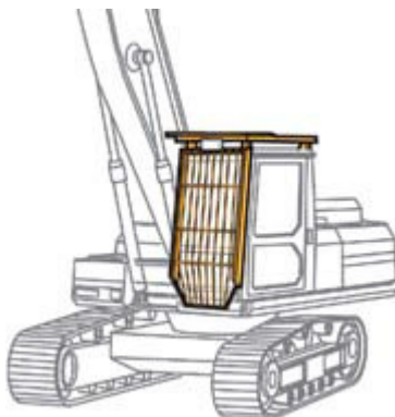
Rys. Konstrukcja zabezpieczająca przed spadającymi przedmiotami
